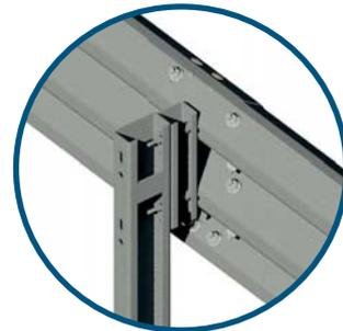
La barrera metálica simple de alta contención "CPS10 H2 1.33" es una barrera de seguridad específicamente diseñada para ser instalada en los márgenes y medianas de las carreteras. Está compuesta por una valla de perfil triple onda unida al poste mediante un elemento separador que funciona, a la vez, como distanciador y como absorbedor de energía durante el impacto
